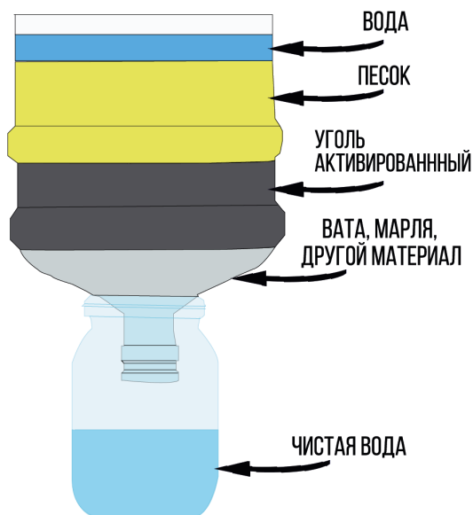
Рис. 23. Фильтр для очистки воды
